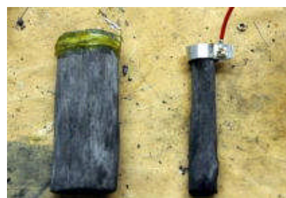
電線の引き出し
