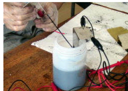
アルミに炭が固定できず塩水が炭で黒くなった。
