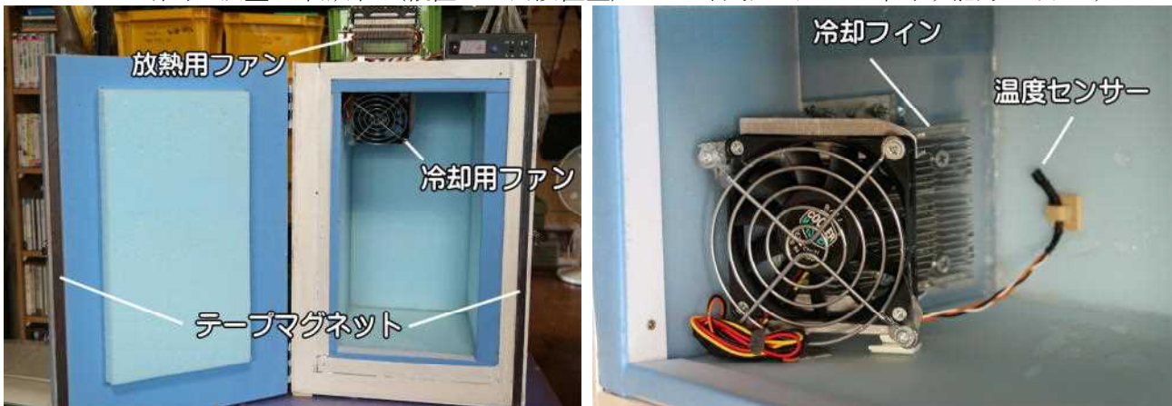
ーペルチェ素子2段重ね冷蔵庫（縦置 室内設置型）ー 外気温より 27℃ 冷やす能力があります
