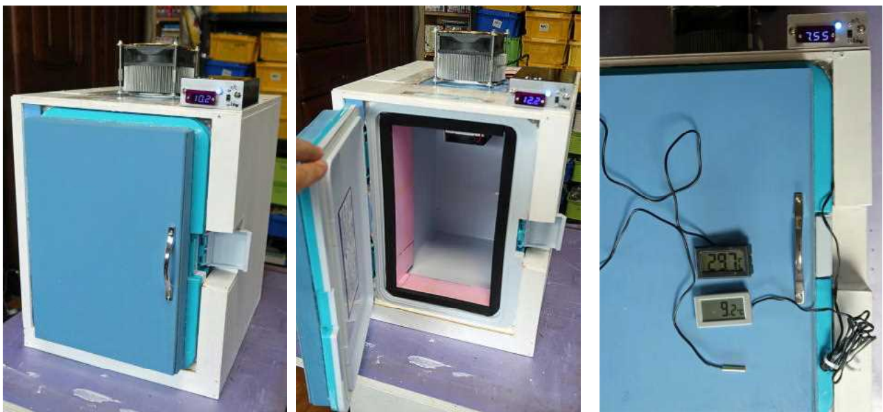
ーペルチェ素子1段冷蔵庫（横置 車載型）ー 12V、2.4A で動作 外気温より 20℃ 低下
