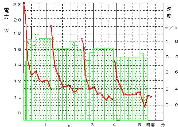
折り返しのコースを走行したので、電池のエネルギーにもロスが生じ、停止していた自動車が約1m/sの速度になるには、運動エネルギーを計算すると、約32Jのエネルギーが必要になる。電池の出力の変化をみると始動時に大きな電力を発生しているのはこのためである。
